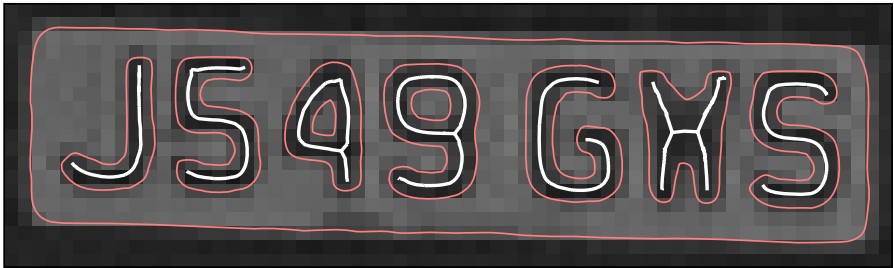
(d) light red : contours (after relevance filtering), white : pruned CAT skeletons
